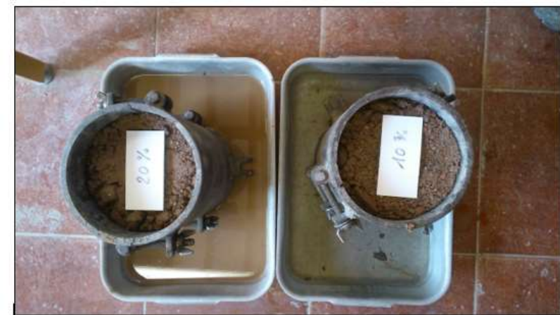
Figura 1: Provini cilindrici di Stabilizzato Ecologico 0/30 al 10% e 20% di umidità
